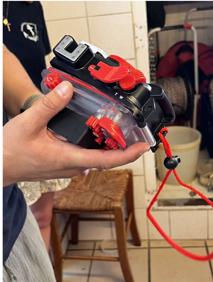
Appareil photo sous marin qui permet de prendre des photos à 40 mètres de profondeur
