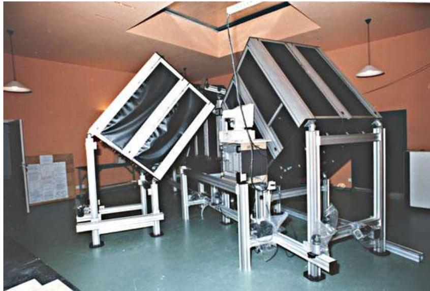
Télescopes de réception du lidar Doppler destiné à la mesure du profil vertical de vent.
