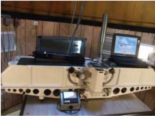
Spectromètre Dobson destiné à la mesure de la colonne totale d'ozone
